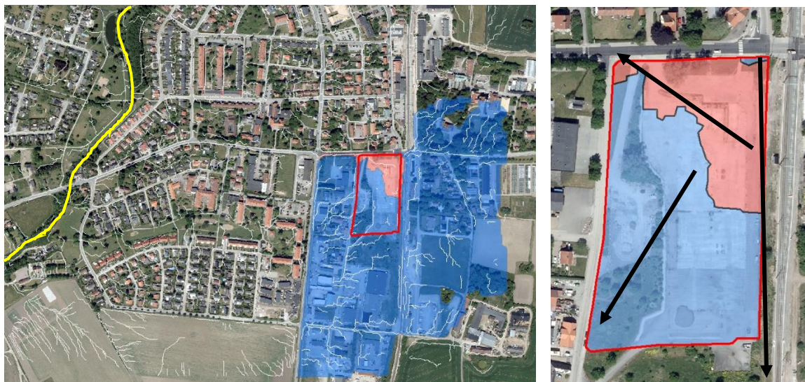
Figur 3. Avrinningsområden för planområdet. Till höger visas en inzoomad vy av avrinningsområdesgränserna inom planområdet. Blått avrinningsområde leds mot lågpunkt sydost om planområdet med vidare avledning mot Svalövsbäcken genom bebyggt område. Rött avrinningsområde avleds längs med Rönnebergsvägen mot Svalövsbäcken. I nordöstra delen av planområdet avrinner vattnet inom blått avrinningsområde söderut mot Industrigatan innan det rör sig vidare mot lågpunkten sydost om planområdet.
