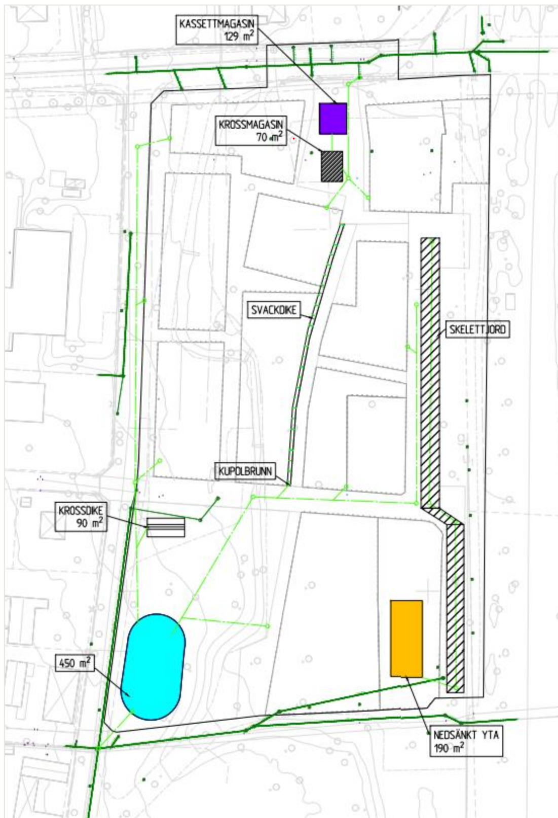
Figur 11. Föreslagna dagvattenåtgärder inom utredningsområdet.
